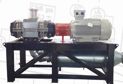
Surpresseur gaz SVH 25 avec garniture mécanique double liquide (eau), isolation thermique sur le corps et sur silencieux. Accouplement direct pour l'utilisation d'une variation de vitesse.
