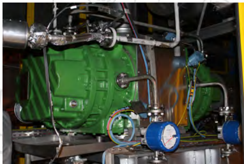
Surpresseur SVH54 avec double garniture mécanique gas.
